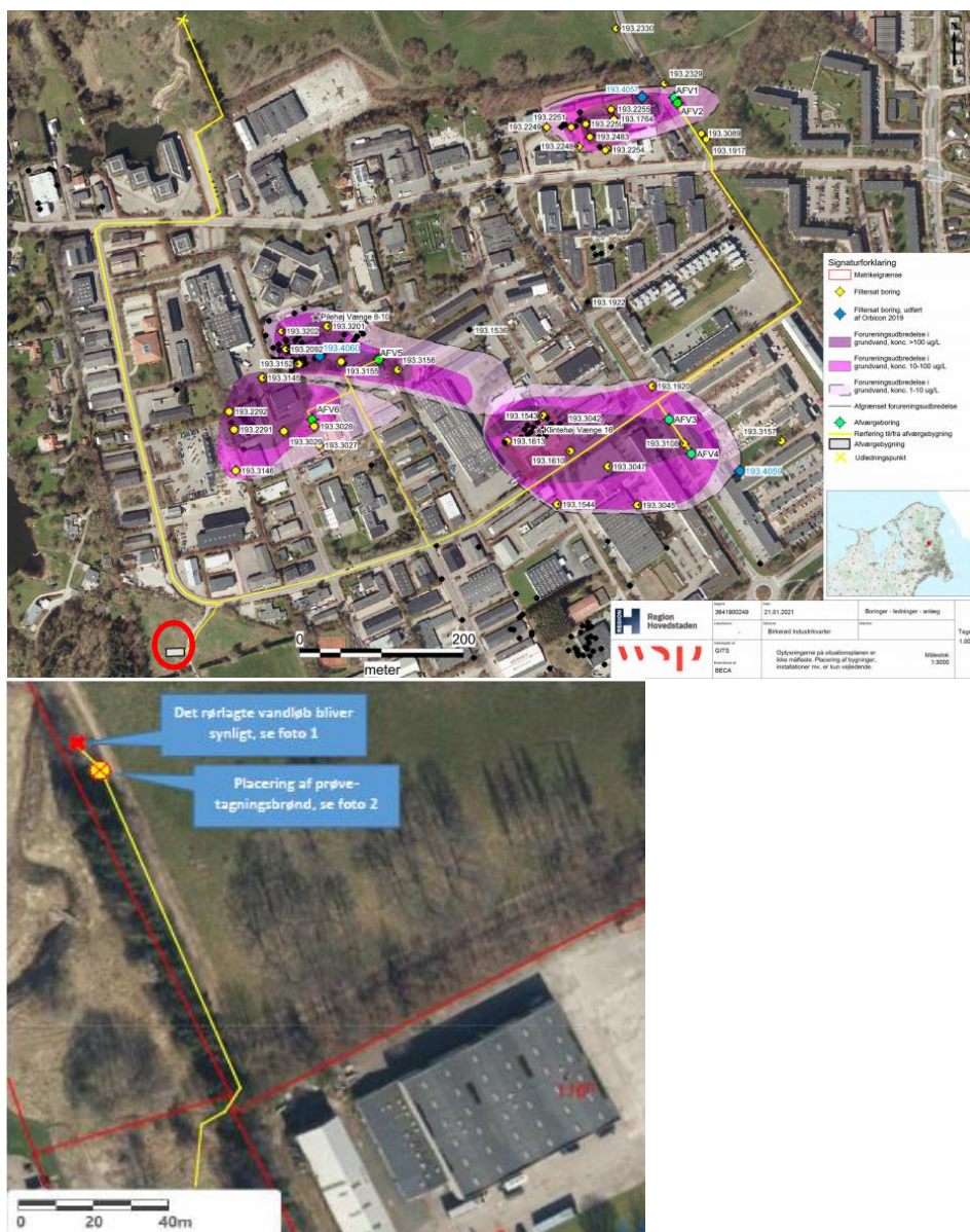
Figur 1. Øverst) Situationsplan for etablering af afværgeboringer, ledningsføringer og afværgeanlæg i Birkerød Industri kvarter. Afværgeanlægget er fremhævet med rød cirkelmarkering. For større billede henvises til bilag 1. Nederst) Udløbsledningens forløb til målebrønd/prøvetagningsbrønd og videre til udløbspunkt i Sideløb til Kajerød Å, hvor vandløbet går fra rørlagt til åbent vandløb (vist med rødt kryds).
